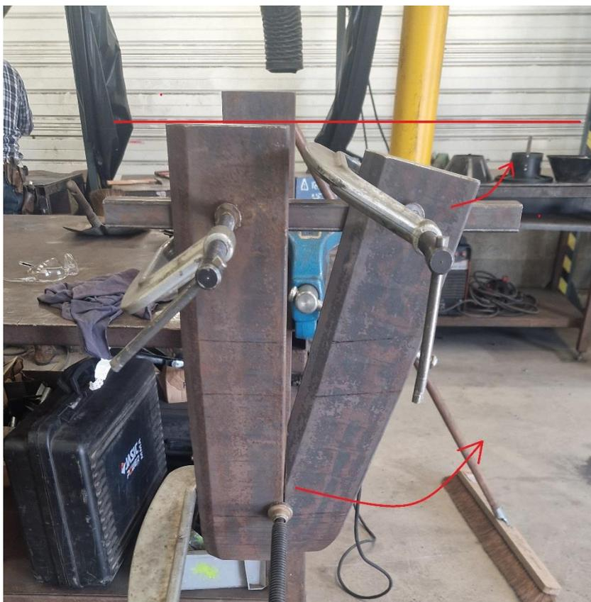
Il est normal que la contre-lame n'arrive pas à la hauteur de lame principale. L'usage de la lame et la pénétration dans le sol veulent qu'un angle vers l'arrière soit donné en position neutre (qui peut être augmenté grâce à l'oblong de réglage qui sera réalisé par la suite). Ces deux dernières se retrouveront donc au même niveau une fois sur le châssis.
