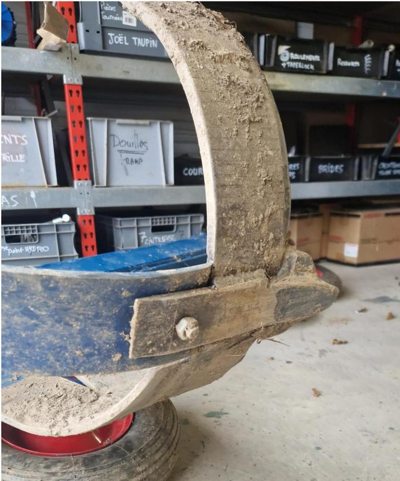
Positionner la mise de soc, le support de déversoir et le déversoir. (Lors de la pose du déversoir, il est possible que la pointe de la contre-lame soit légèrement à découper afin qu'il plaque bien contre la lame principale).
