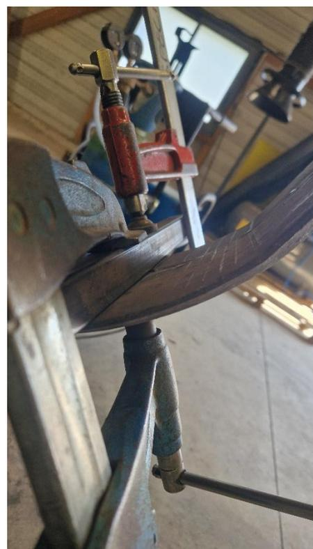
**Soudage :** Souder proprement les lames entre elles et arraser les soudures.
