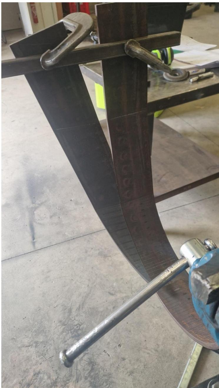
Repositionner ensuite les deux lames en les bridant à l'aide d'un montage plaquette (ci-contre avec un tube carré) afin de les aligner dans le même plan.
