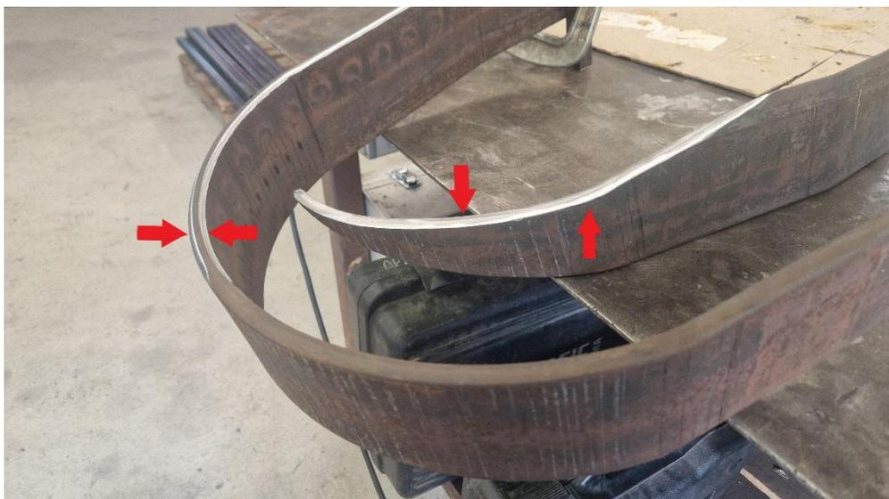
Réalisez un chanfrein de part et d'autre des deux lames ou elles sont en contact. Cela a pour but d'aider la pénétration lors du soudage et de pouvoir arraser les soudures pour ne pas créer de points de résistance dans le sol (bourrelet dû au cordon).
