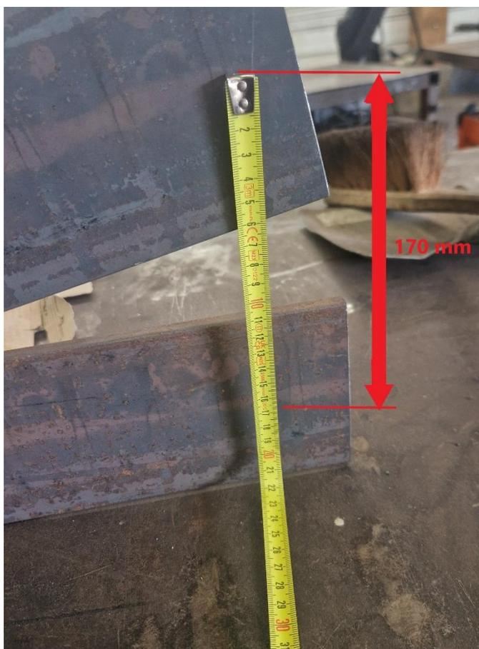
En parallèle de cette étape, il faut également s'assurer que la côte de 170mm (entraxe des trous pour reprise sur châssis) se trouve bien approximativement au centre des deux lames.
